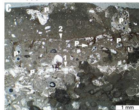
Plusieurs surfaces durcies (1 et 2) au sommet de la Calcarénite d'Haudainville. Chacune de ces surfaces est perforée (P). Au cours du temps l'évolution des dépôts indique un environnement de plus en plus calme
