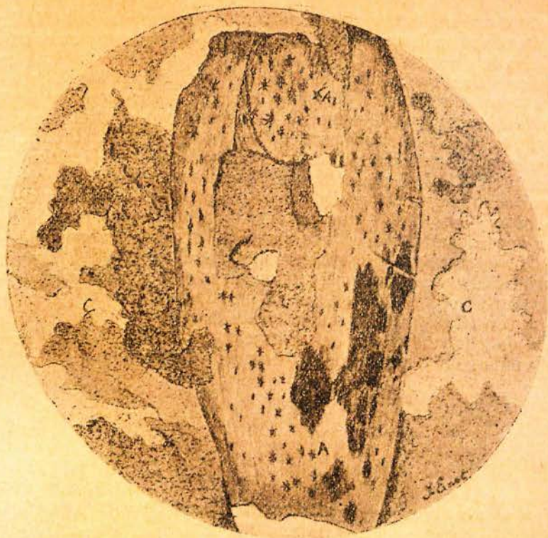
Grossissement 1/50 Dessiné à la chambre claire. FIG. 3. — Coupe du calcaire du Muschelkalk supérieur de Mont-sur-Meurthe, avec débris osseux microscopique inclus. AA. Ostéoplastes injectés d'une matière minérale noire. B. Lamé d'une substance minérale verte. CC. Calcaire encaissant.
