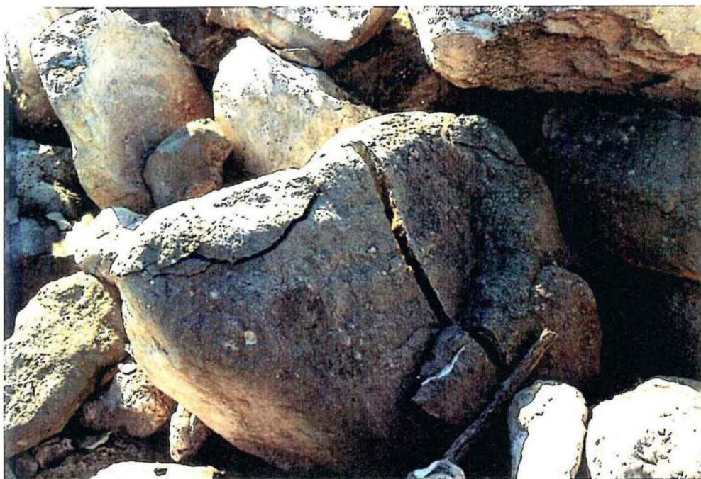
*Fig. 28. Lac du Der. Enrochement en calcaire de Gudmont oolithique présentant à la fois un écaillage et un éclatement à coeur.*
