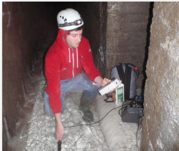
Figure : mesure de la conductivité dans la galerie
