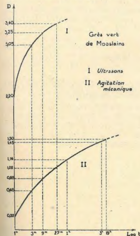
FIGURE 4. — Comparaison des dispersions mécanique et ultrasonique (en ordonnée : degré de dispersion mesuré par le poids en mg de particules inférieures à 1\ \mu contenues dans 1 cm 3 ).
