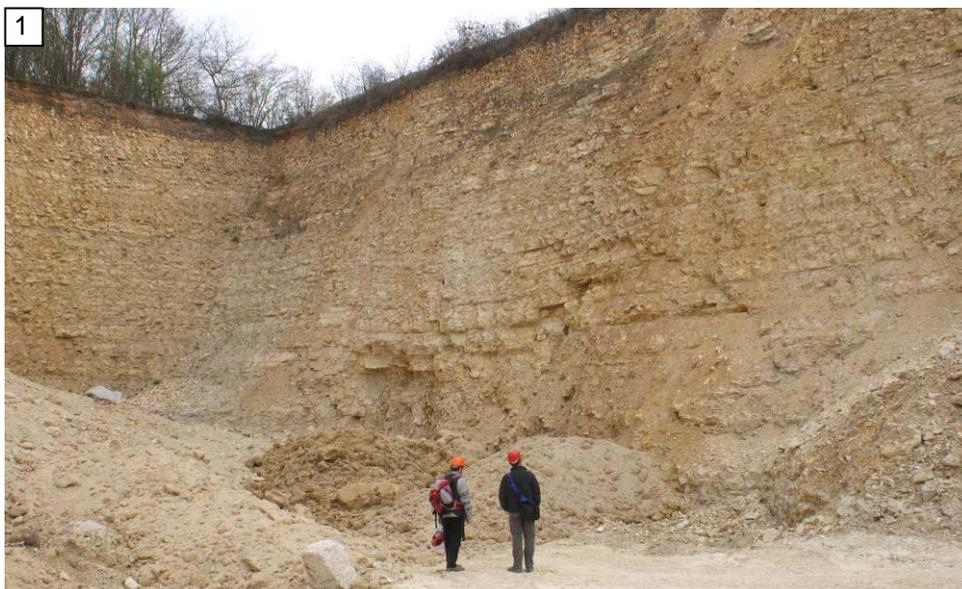
1. Carrière de Feray en cours de remblaiement : succession de bancs calcaires relativement réguliers quasi azoïques (Calcaires de Levroux supérieurs)
