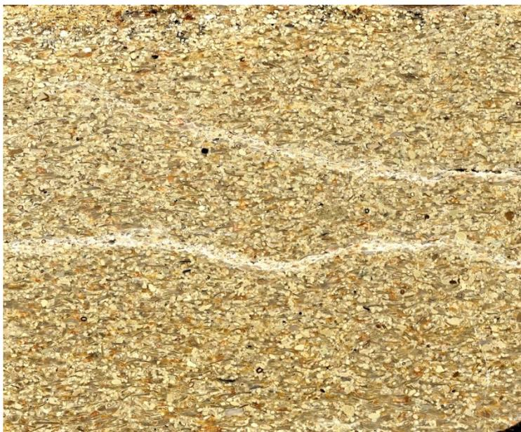
Figure 8 – Calcaire sableux coquillier à oolithes de micrite.
