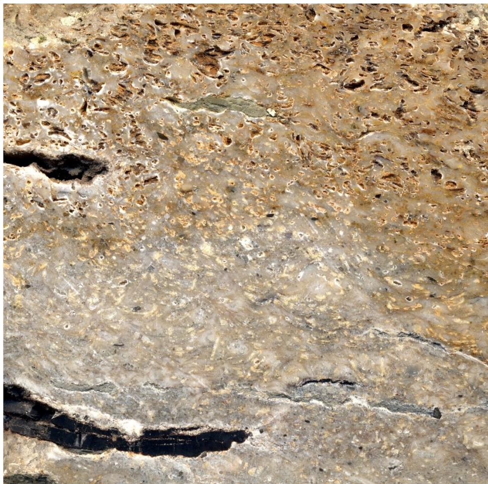
Figure 4 – Calcaire siliceux fossilifère de deux types et lignite.
