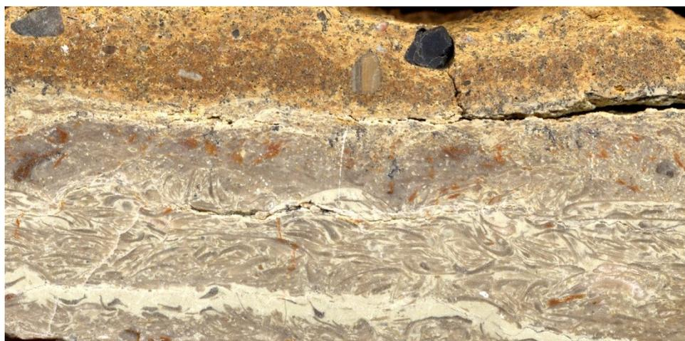
Figure 6 – Calcaire lumachellique et grès calcaire à galets de phtanite.
