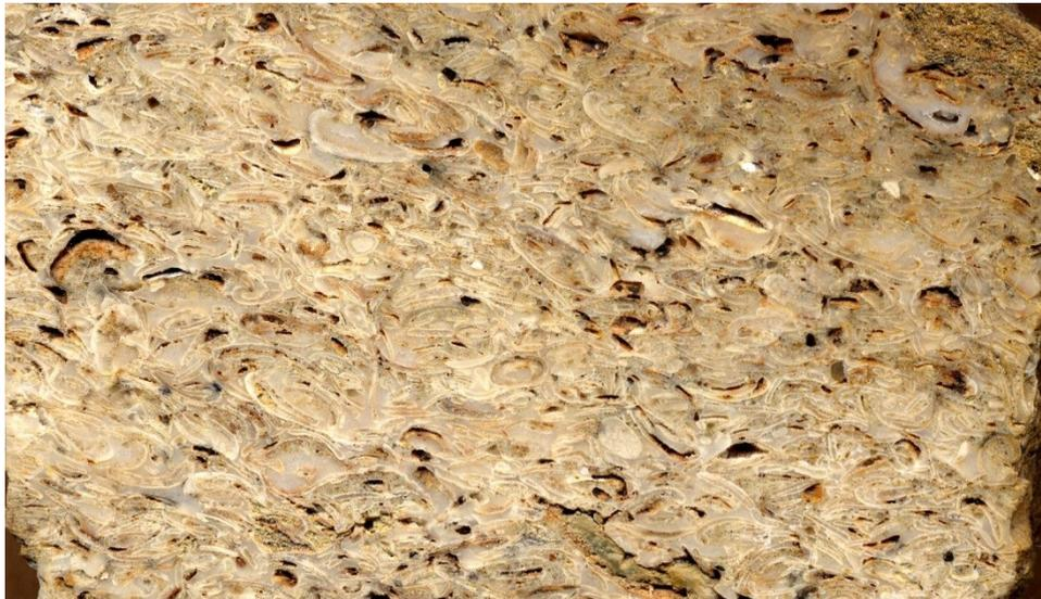
Figure 3 – Calcaire siliceux fossilifère du grand appareil.
