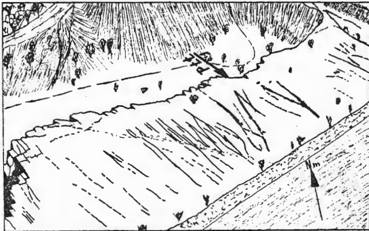
Fig. 77c - Relevé de fractures ouvertes sur une vue aérienne oblique de la découverte SE ( longueur : environ 230 mètres )
