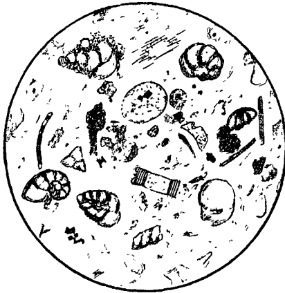
FIG 30 — Lame mince de tuffeau siliceux de Gignon vue au microscope (80 diamètres)
