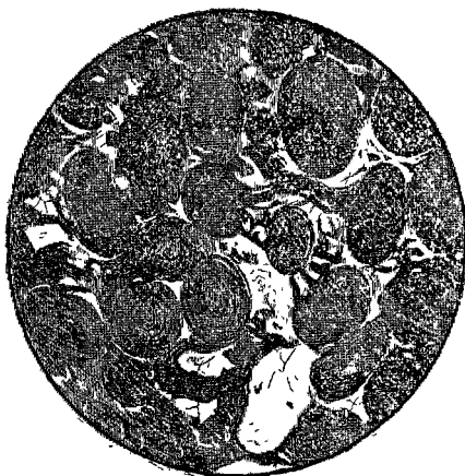
FIG 19. — Coupe mince montrant au grossissement de 80 diamètres la structure du minerai de fer oolithique des environs de Nancy
