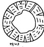
Abb. 86 b Karbonat dringt konzentrisch vom umgebenden Kalk in ein Silikatoid, Bohrg. Fallersleben 1, 182,7 m T.
