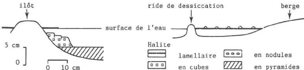
Fig. 41. - Importance de la microtopographie dans la distribution des types morphologiques de la halite dans une "cabecera" (CO 23) à Santa Pola.
