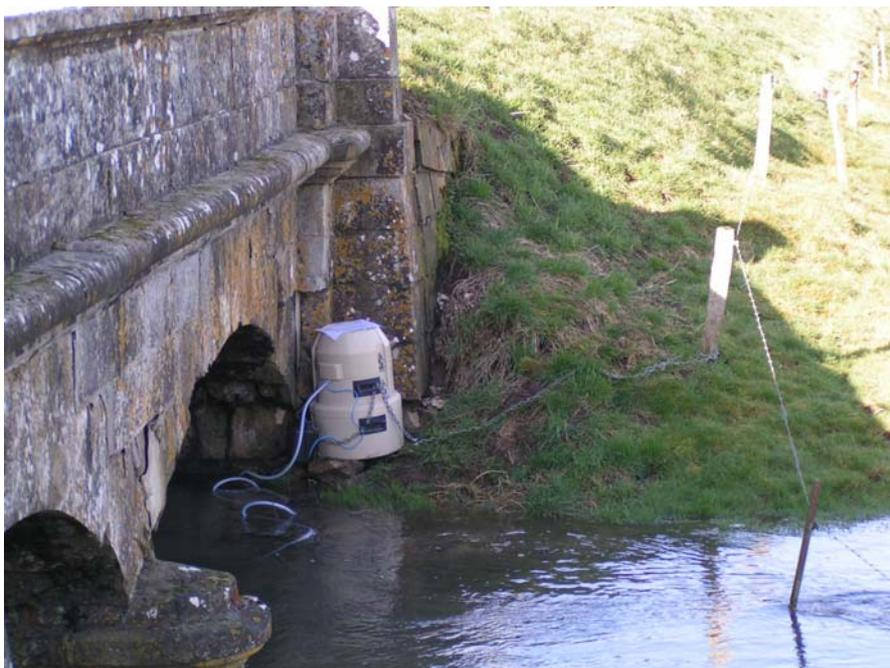
Figure 5-5 : Préleveur automatique posé en aval du pont de Laneuville-au-Bois
