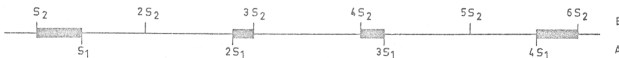
FIG. 8. — Représentation schématique des zones de réflexion d'un édifice interstratifié formé de feuillets de type A et B.
